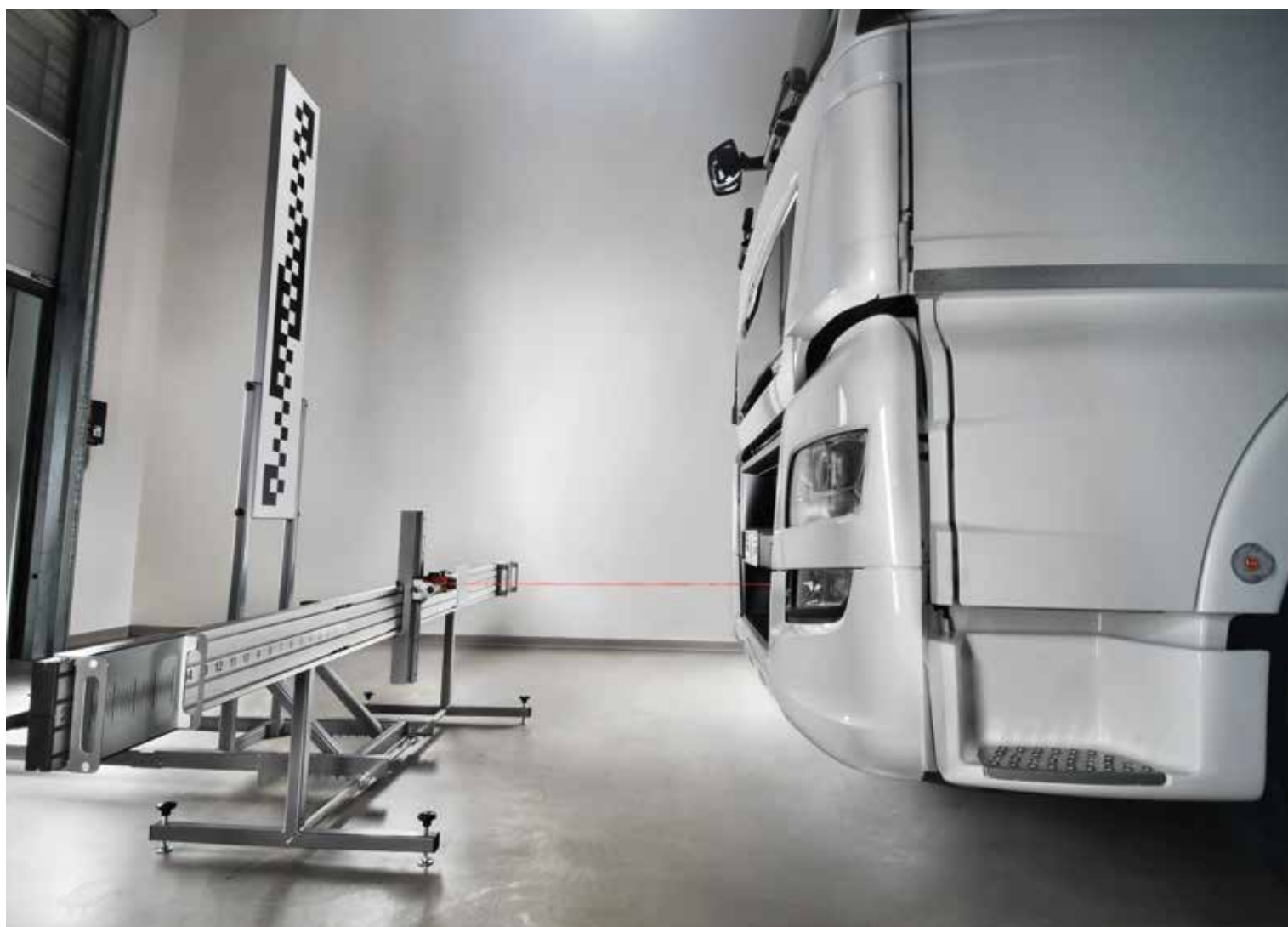
Escala graduada magnética para el control de la alineación del cuadro
