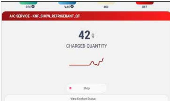
Fase de "carga de refrigerante": la estación garantiza que se alimente la cantidad correcta de gas al sistema del vehículo.
