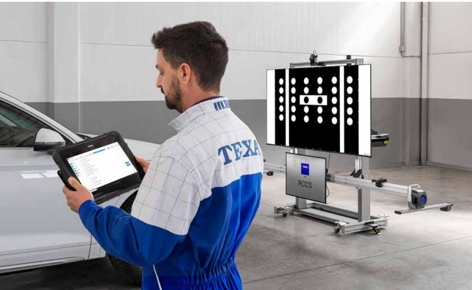
Para la calibración de radares, lidar, cámaras y sensores, TEXA ha diseñado y desarrollado RCCS 3 EVO, una solución de alta gama.
