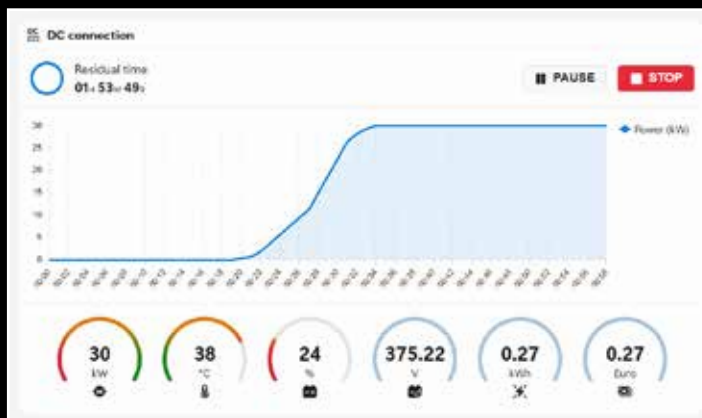
Servicio de recarga en modo DC con mensajes de estado
